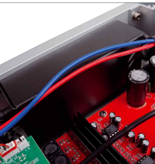
In dem schwarzen Kasten steckt das kompakte Netzteil
